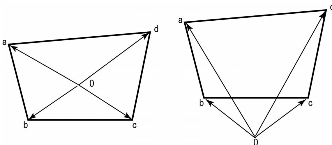
2次元の多角形の面積は3角形に分割して求めることができる。各頂点が反時計回りに配置してある場合ある1点と隣り合う頂点2つの3角形の面積の合計が面積である。例えば図のOabの面積は、
